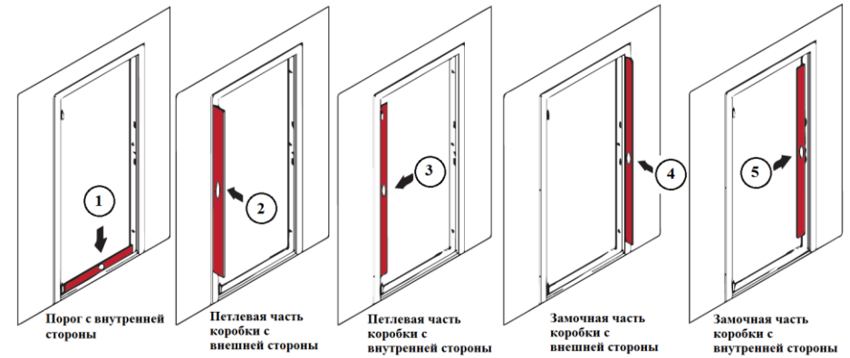
Рис.8 Схема контрольных замеров дверного блока уровнями
